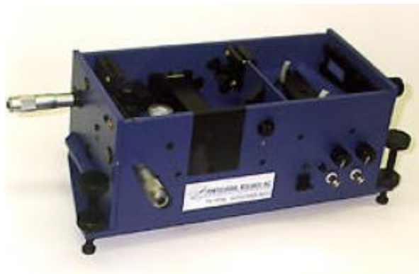
图(2), 去掉上盖的自相关仪
